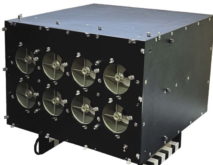
Рис. 1. Фотография научной аппаратуры “Солнце-Терагерц”: вид со стороны лицевой панели. Показаны входные окна телескопов, малые и большие зеркала.
