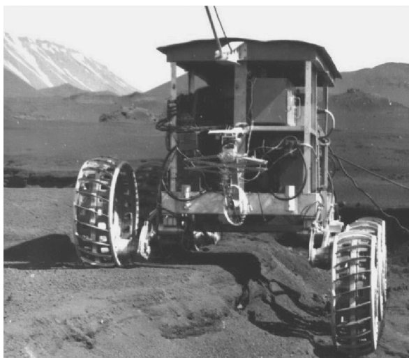
Рис. 8. Фрагмент испытаний экспериментального образца самоходного автоматического шасси при регулировании относительного положения колес и корпуса по вертикали в районе недавних извержений вулкана Толбачик на Камчатке.
