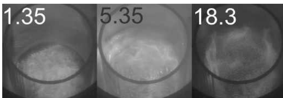
Рис. 16. Кадры развития микроволнового разряда в образце имитатора лунной пыли LMS-1D. Время начала кадра (миллисекунды) от момента пробоя указано на каждом кадре в левом верхнем углу. Время экспозиции кадра 100 мкс. Мощность микроволнового излучения 400 кВт, длительность импульса микроволнового излучения 6 мс.
